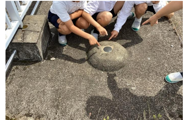
三角点発見 北校舎屋上(音楽室の上付近)
